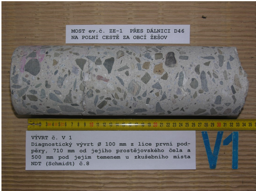
Obr. E62-1 VÝVRT č. V1. Diagnostický vývrt \varnothing 100 mm z líce 1. pod- pěry, 710 mm od jejího prostějovského čela a 500 mm pod jejím temenem, u zkušebního místa NDT (Schmidt) č.8.
